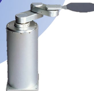
半導体ウエハー搬送用ロボット (株)ダイヘン様提供
